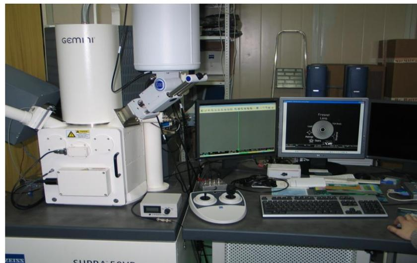
Система е-литографии **ELPHY PLUS** на основе микроскопа **SUPRA 50VP**
