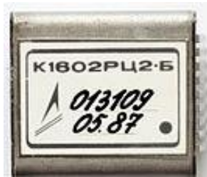
Память на цилиндрических магнитных доменах
