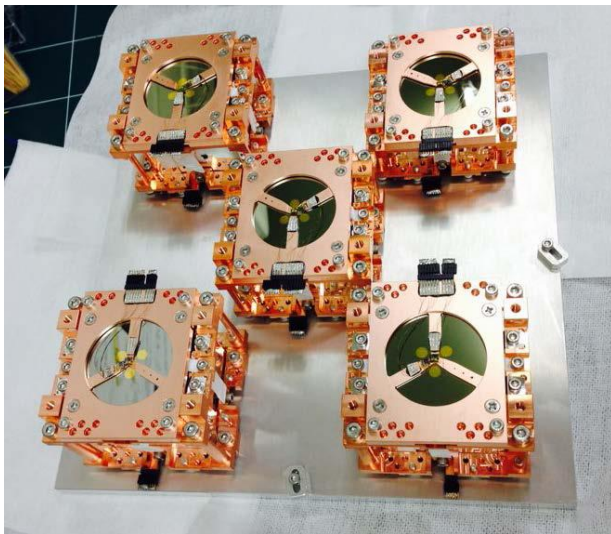
Сцинтилляционный элемент из кристалла молибдата кальция ( ^{40}\text{Ca}^{100}\text{MoO}_4 ) в сборе с сверхпроводящим болометром
