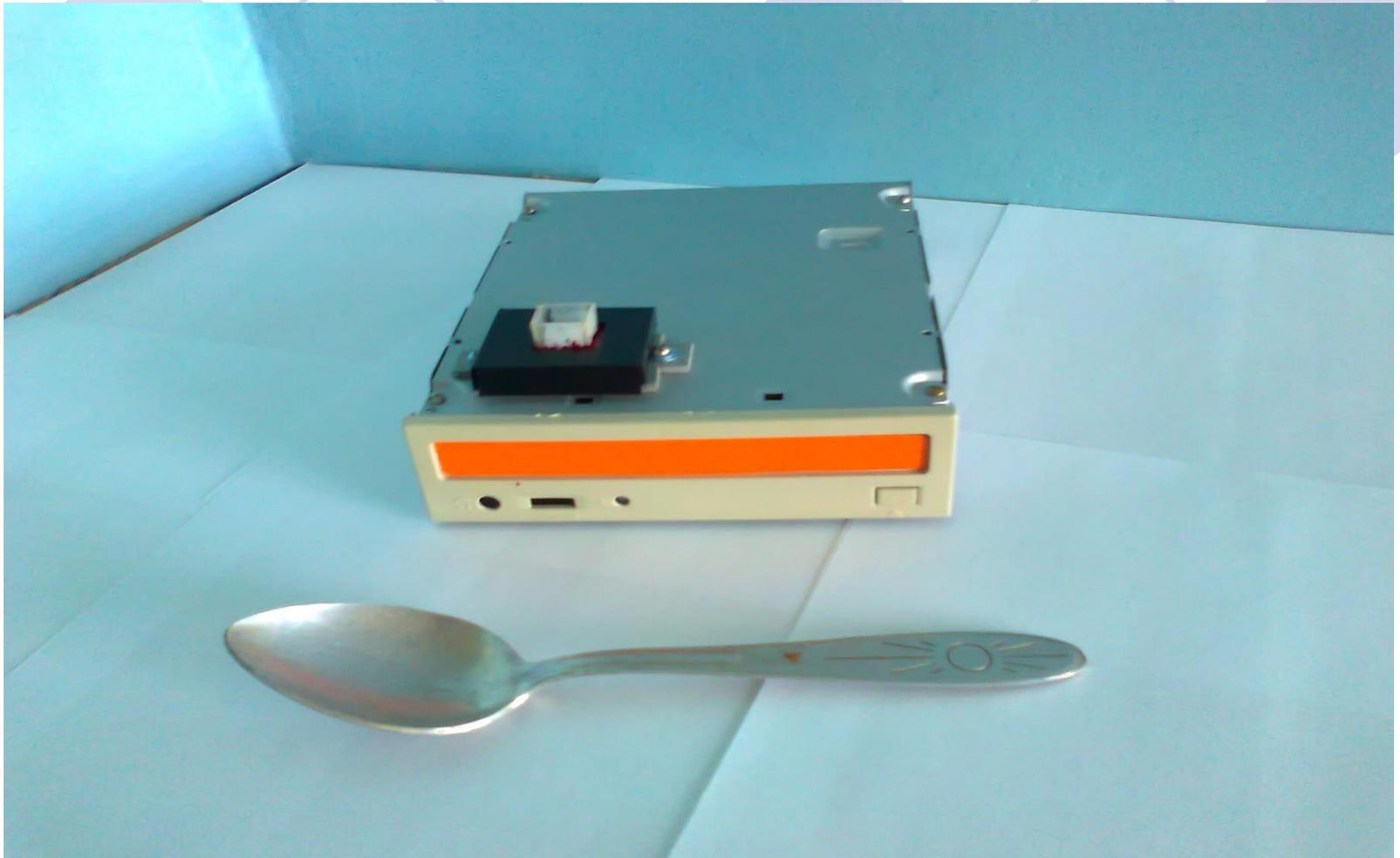
Датчик, включающий резонатор с жидкостной ячейкой и электронную схему для получения информативного сигнала, который непосредственно сопрягается с компьютером
