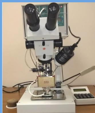
Рис. 5. УЗ микросварка
