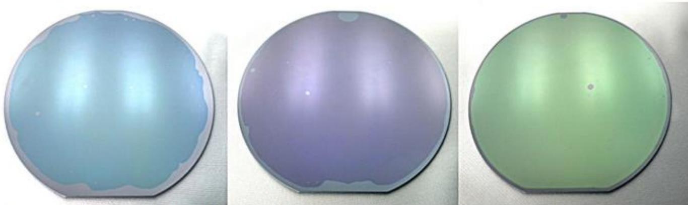
Рисунок 9. Фотографии 100 мм КНИ пластин, созданных методом водородного переноса 0.5 мкм слоев Si на кремний с PEALD  $\text{HfO}_2$  и  $\text{Al}_2\text{O}_3$  стеками одинаковой толщины, но с разным чередованием слоев: 20 нм  $\text{Al}_2\text{O}_3$  под слоем (100) Si 500 нм (а); 20 нм  $\text{HfO}_2/\text{Al}_2\text{O}_3$  под слоем (100) Si 500 нм (б); 20 нм  $\text{Al}_2\text{O}_3/\text{HfO}_2/\text{Al}_2\text{O}_3$  под слоем (100) Si 500 нм (в).
