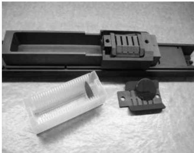
Ростовое графитовое устройство для ЖФЭ (ООО «МеГа Эпитех»)
