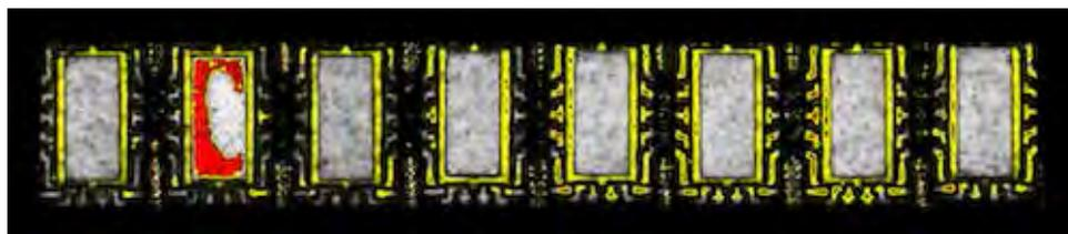
*Рисунок 4. Акустически сформированное изображение полосы памяти из восьми приборов с использованием излучения 120 ГГц*
